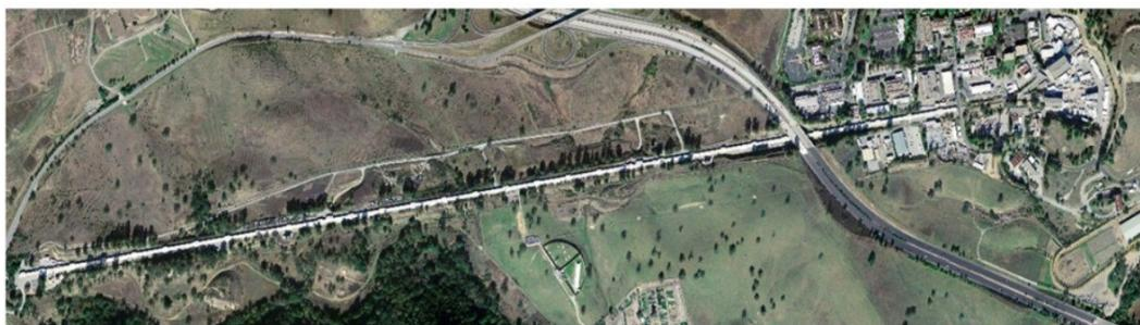
그림 1. 스탠포드선형가속기센터(SLAC)의 3.2 km 길이 전자선형가속기 모습. 2.856 GHz의 마이크로파를 가속관 속에 보내어 전자를 고에너지로 가속함.
